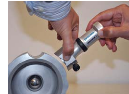
Figure 18: Portable Rockwell avec pieds spéciaux
