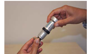
Figure 17: Portable Rockwell avec trépied
